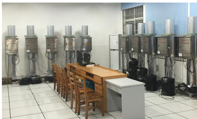
图 4 暂态信号故障定位实验平台
