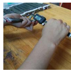
c) 测量试件宽度
